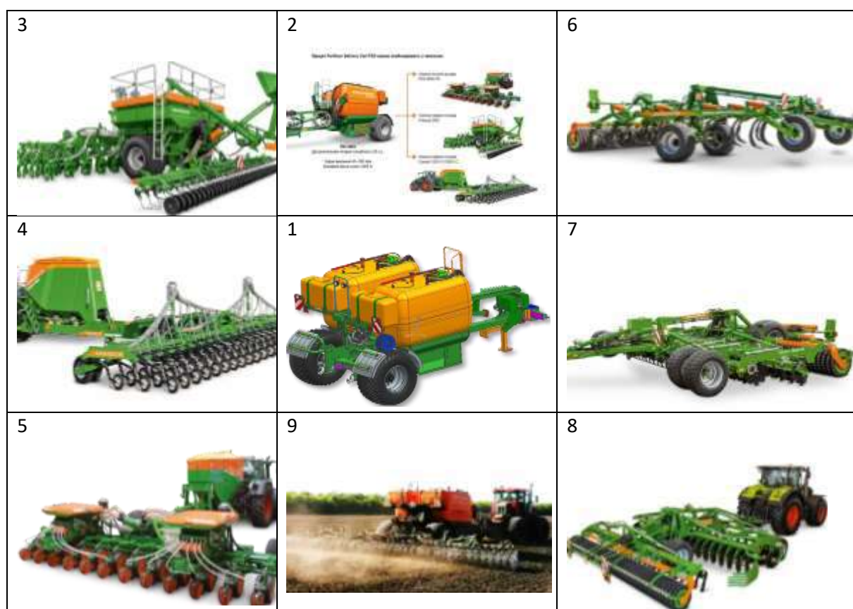
Рисунок 1 - Системный комплекс машин АО «Евротехника» (г.Самара) на базе FDC-6000 (1,2) для работы с жидкими удобрениями: 3-сеялка Primer DMC; 4-сеялка Condor; 5-сеялка EDX; 6-культиватор Senius; 7-дискатор-средняя дисковая борона Catros; 8-дискатор-тяжелая дисковая борона Certos
