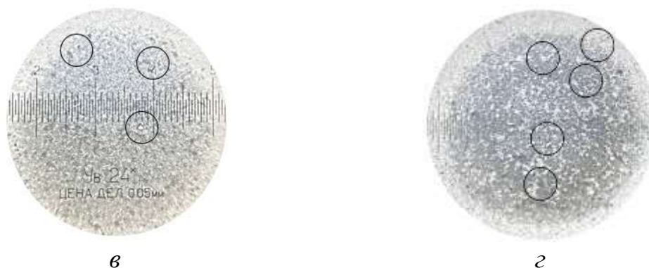
Рисунок 6 – Частицы загрязнений в моторных маслах с различной наработкой: a – 0 ч; б – 30 ч; в – 125 ч; г – 250 ч
