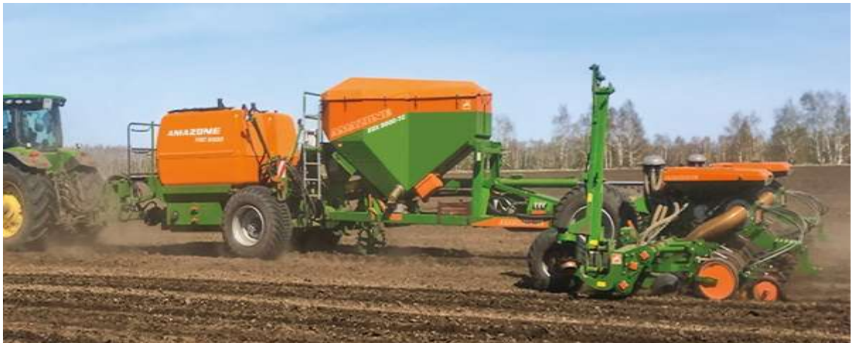
Рисунок 3 - Агрегат для посева сеялкой EDX с внесением жидких удобрений КАС с помощью FDC-6000
