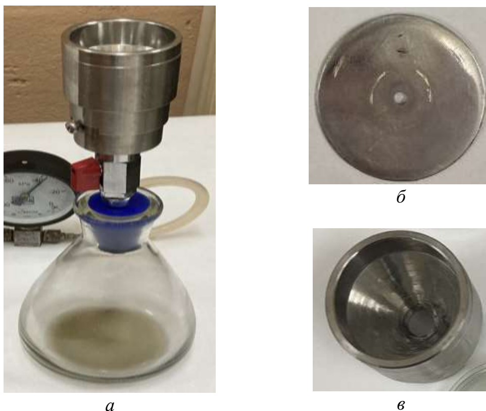
Рисунок 4 – Модернизированная установка для патч-тестирования: а – внешний вид; б – концентрирующая прокладка; в – воронка
